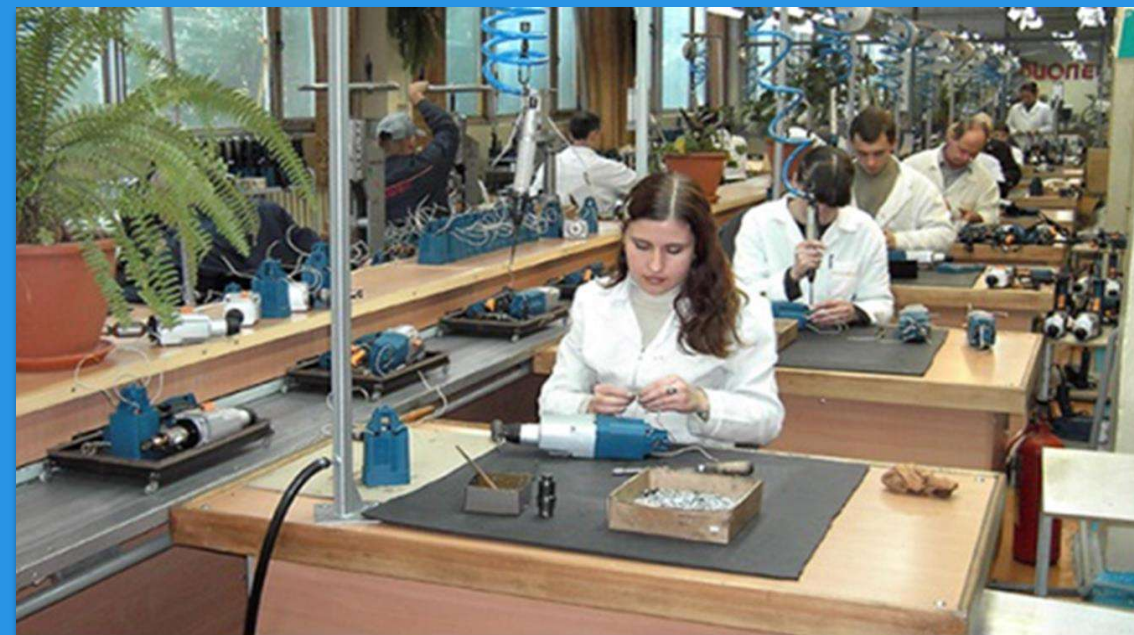
Сборка электроинструмента на конвейерах с заданным тактом
