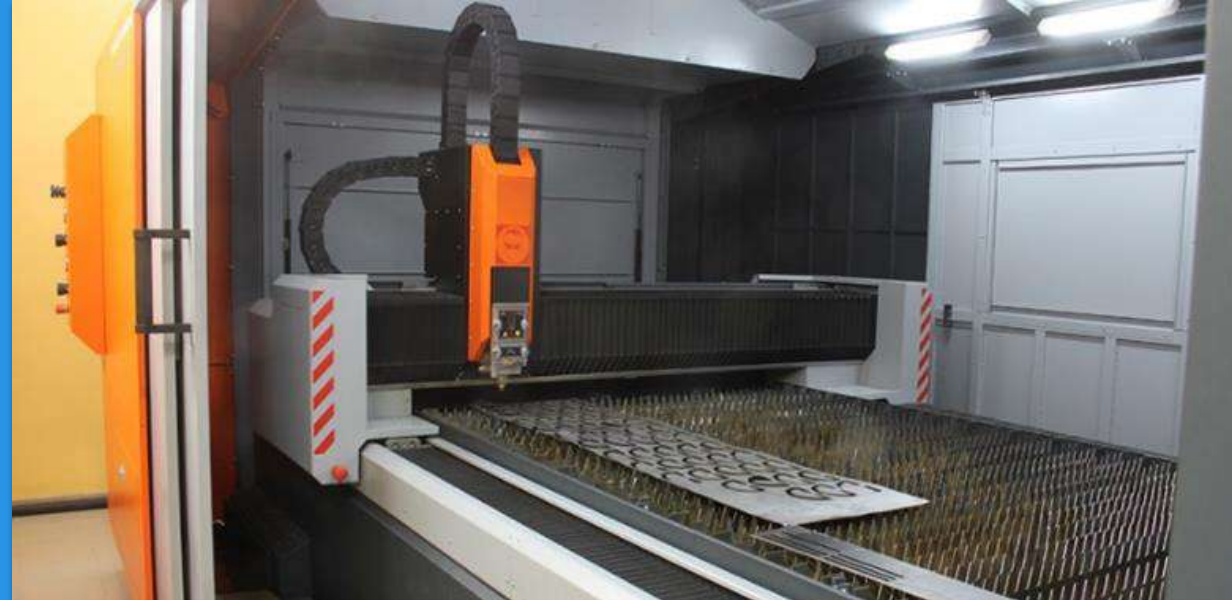
Раскрой листового металлопроката при помощи волоконного лазера мощностью 2 кВт. LaserCut Professional от компании «UNIMACH» (Россия)
