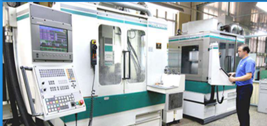
Механическая обработка корпусных деталей из AL- сплавов производится на прецизионных 4-х, 5-ти координатных обрабатывающих центрах Ricoma (швейцарской фирмы FEHLMANN AG)
