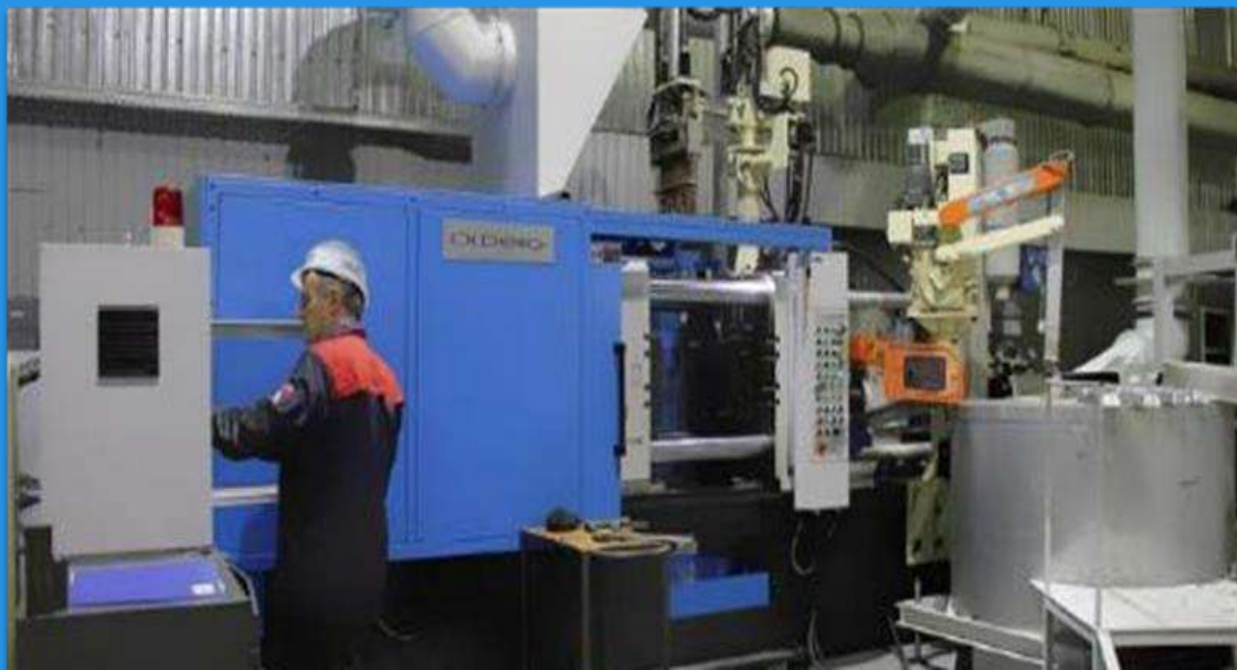
Роботизированный литейный комплекс с ЧПУ. Машина литья под давлением OLDENG C300D Изготовление литейных заготовок из цветных металлов и их сплавов методом литья под давлением.
