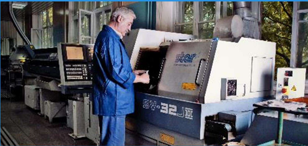
Линия высокопроизводительных автоматов. Прецизионный двухшпиндельный токарный автомат с приводным инструментом STAR SV-32 японской фирмы STAR предназначен для изготовления деталей сложной формы.
