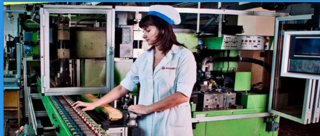
Якоря и статора изготавливаются на автоматических линиях итальянской фирмы AXIS.
